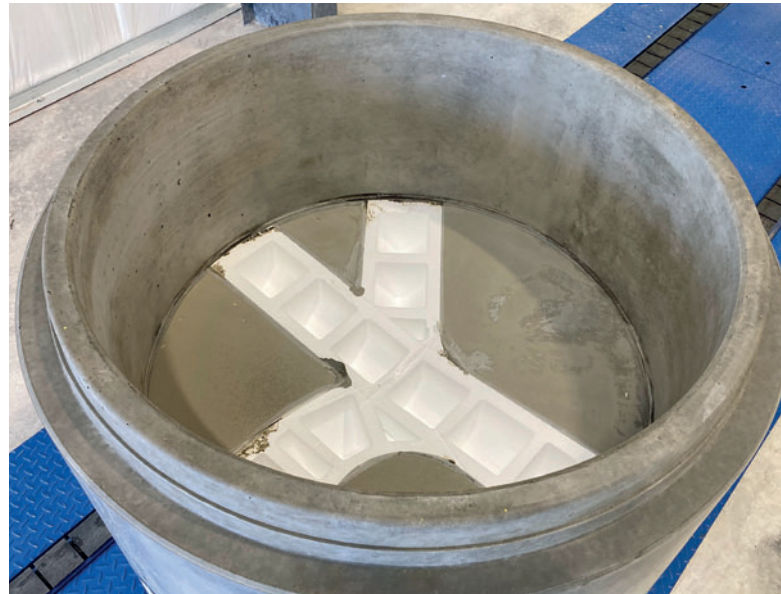
Эффективное производство монолитных колец с дном
