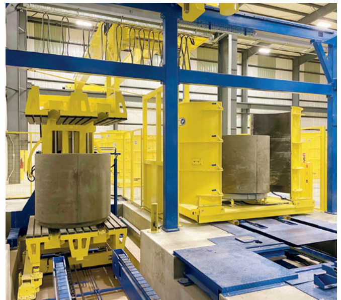
При необходимости извлеченные из формы изделия автоматически поворачиваются на 180 градусов
