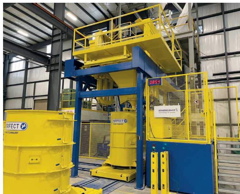
Формы постоянно доступны для бетонирования СУБ
